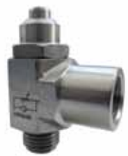
VXREL Regulador caudal INOX-316 unidireccional. Presión trabajo: 10 bar. Temperatura: 120°C. Rosca BSP. Posibilidad bajo pedido de roscas NPT y SAE.
